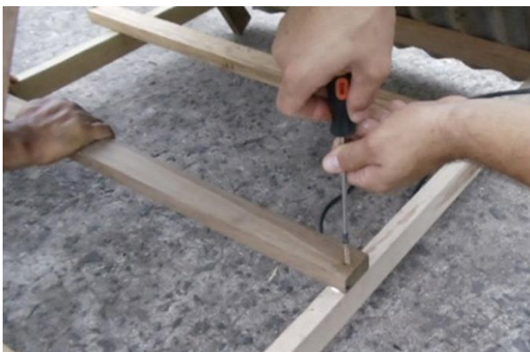
Atornillando los apoyos para las gallinas
