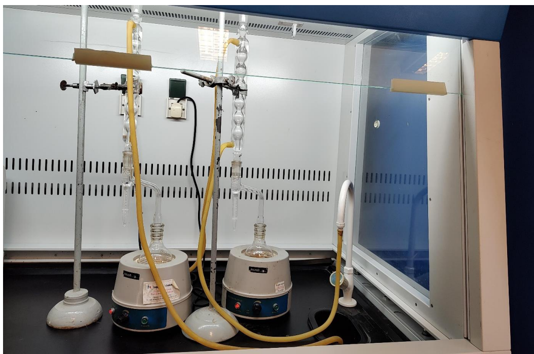
Imagen 30: Método de Dean-Stark o Marcuson para determinar la humedad de alimentos deshidratados.
