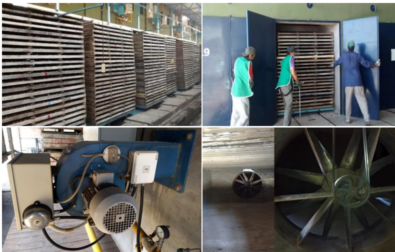
Imagen 25: Componentes de un horno de deshidratado de ciruelas. Gentileza: Productos Andinos S.A. y Sergio Morbidelli.
